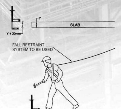
STEP 2.0: SLIDE CLAMP INTO POSITION & HAMMER TIGHTEN THE NUT, ENSURE THE INSTALLER IS ATTACHED WITH FALL RESTRAINT SYSTEM
